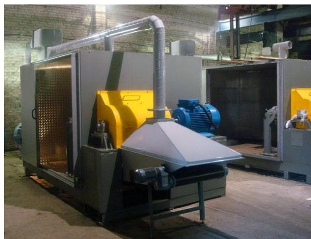
Оборудование представляет собой небольшой «контейнер», изготовленный из полиметалла с высокой степенью вибро и звукоизоляции, с боковым способом загрузки сразу нескольких автошин в оправку. Общая ширина сборки шин, не более 800 мм. Оправка, вращаясь со скоростью 50 об/мин. подает шины на фрезу, имеющую скорость вращения 3000 об/мин., где происходит процесс резания.
