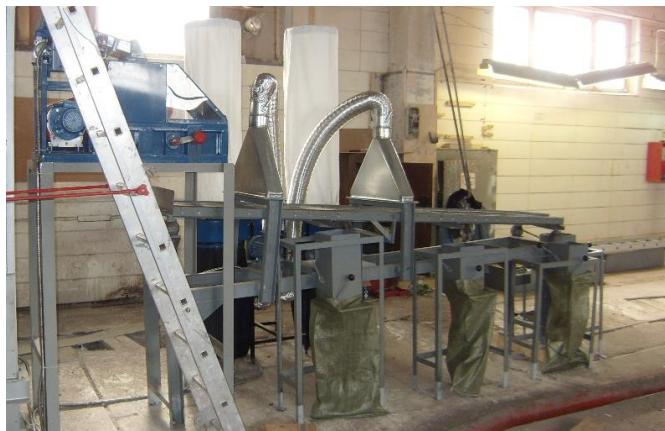
В процессе работы мини-завода на выходе получается продукция с высокой степенью очистки, которая сразу упаковывается в мешки, что предусмотрено конструкцией установки
