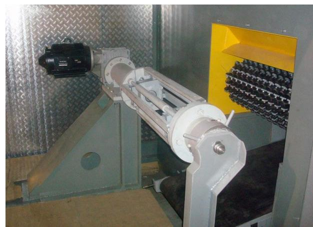
В зону резания подается мелкодисперсная воздушно-водная смесь для охлаждения режущего инструмента.
